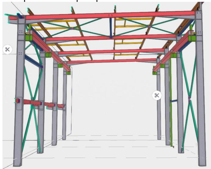
→ Modéliser dans un même fichier ROBOT les 2 palées de stabilité suivantes en modélisant l'action longitudinale du pont roulant comme indiquée sur les schémas mécaniques.
