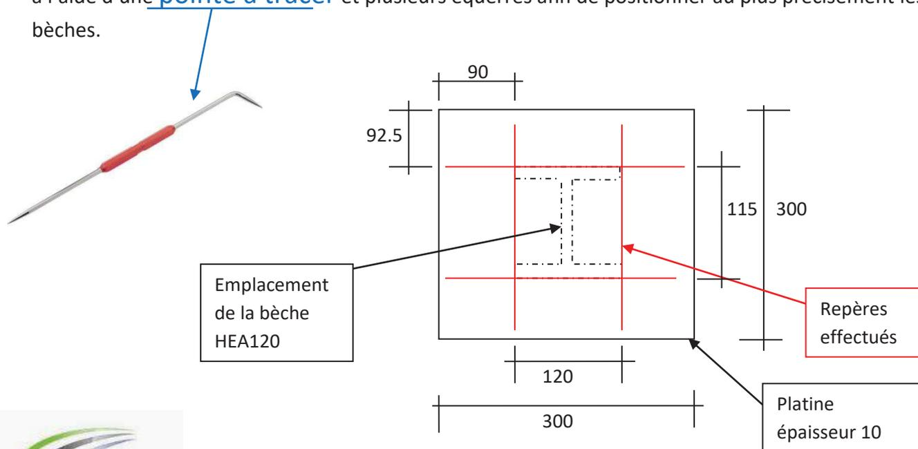
Une fois la bèche correctement positionnée, je l'ai pointée à la platine. Afin de la maintenir en position avant de relier les cordons de soudures.
