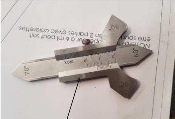
Voici l'outil permettant de mesurer la gorge d'un cordon de soudure
