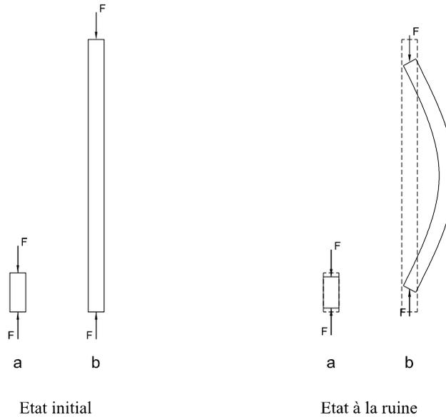
Le flambement est un phénomène d'instabilité touchant les barres comprimées fortement élancées (longueur importante vis-à-vis des dimensions transversales).
