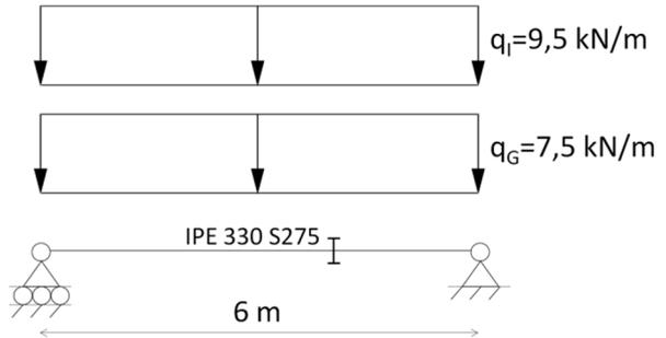
1.1. Montrer que la poutre ne résiste pas au déversement avec  $M_{cr}=103.34$  kN.m
