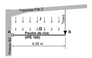
Schéma mécanique de la poutre étudiée (AB), elle est isostatique et soumise aux charges linéaires uniformes :
