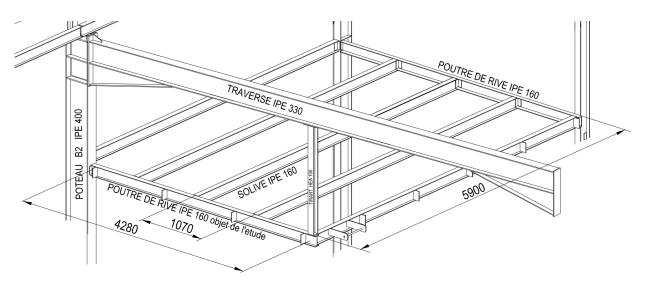
Vue de détail de la poutraison de la mezzanine supportant le plancher en cailleboti avec au premier plan la poutre de rive objet de l'étude. Elle est rattachée au poteau et à la traverse de la file 2.
