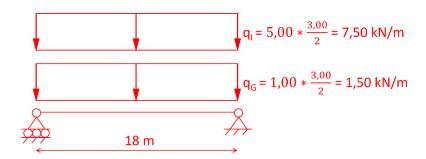
2.1.2. A l'aide des critères ELS  $w_{max} \le \frac{1}{200}$  et  $w_3 \le \frac{1}{300}$ , déterminer l'inertie minimale  $I_y$  de cette poutre.
