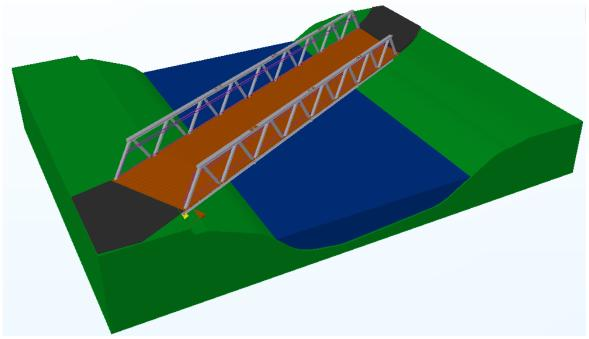
La passerelle est composée de 2 poutres treillis reliées par des traverses permettant de supporter un platelage bois.
