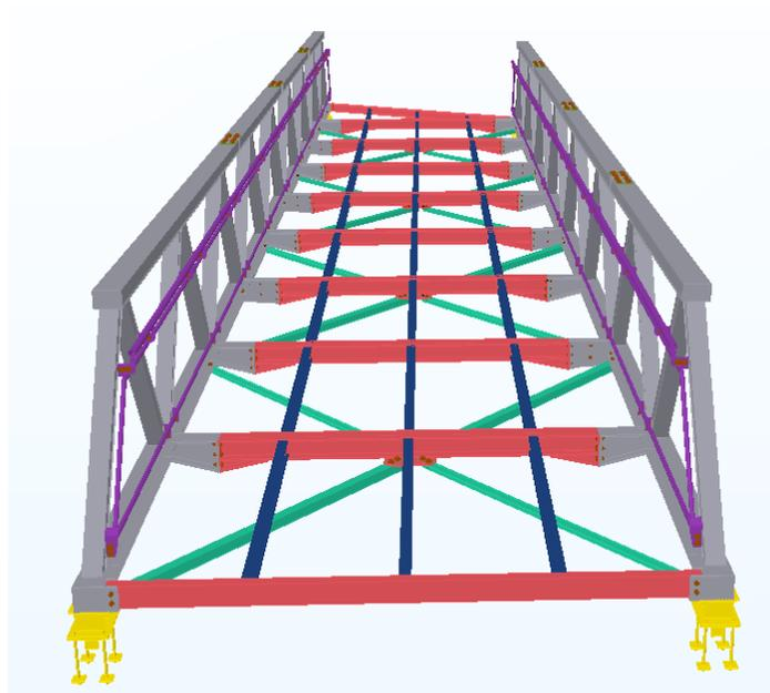
Pour des questions de sécurité des cyclistes circulant sur la passerelle, la hauteur du garde-corps est portée à 1.20 m.
